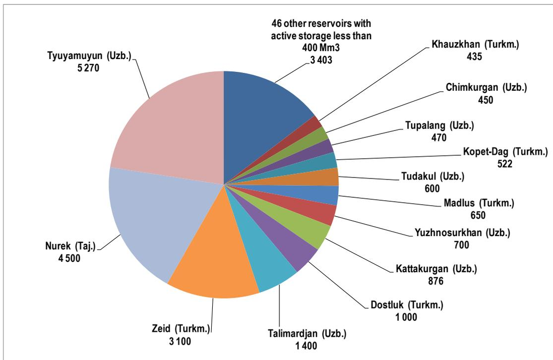
**График 0-18: Распределение мощности регулирования в бассейне Амударьи на водохранилище**
