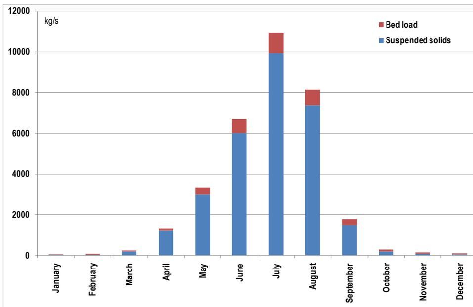
График 0-38: Взвешенные частицы и донные наносы в реке Вахш на территории Рогуна (2010 г.)
