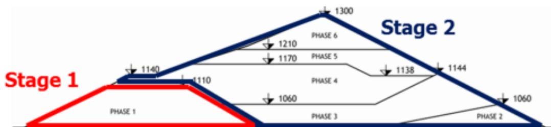
График 3-4: Продольный разрез 1 и 2 этапов строительства
