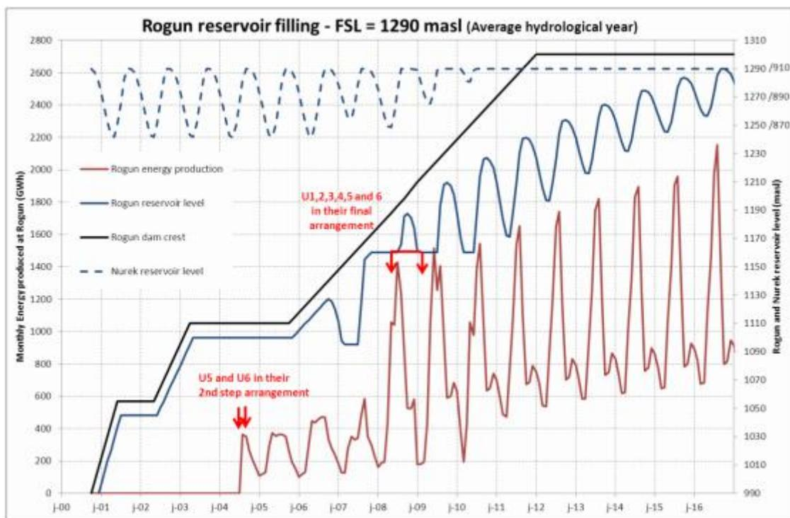
Рисунок 21-3: Смоделированное заполнение водохранилища Рогунской ГЭС
